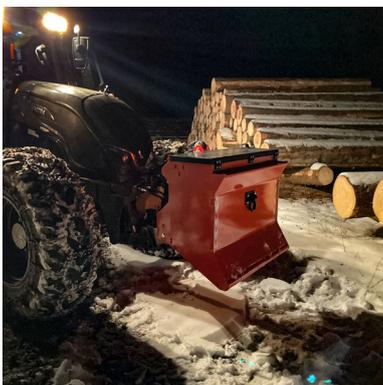
**Demnächst:** Polterschild mit Weiste Gerätedreieckaufnahme, somit kann bei beengten Verhältnissen rasch am Waldrand abgekuppelt werden.
